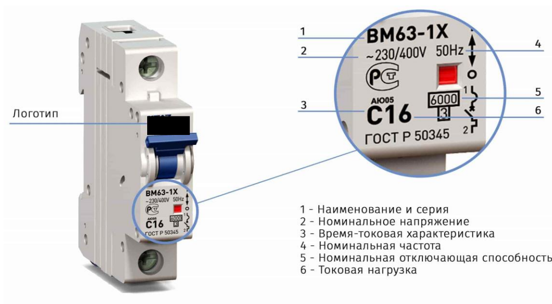
Рисунок 2. Пример маркировки АВ
