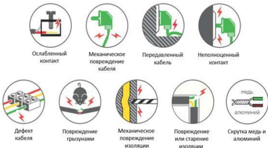
Рисунок 6. Возможные причины искрения в электропроводке
